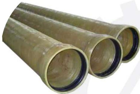
علاوه بر رزین، الیاف شیشه ای پیوسته و الیاف بریده شده، برای ایجاد استحکام حلقوی بالا و تقویت استحکام محوری بکار می روند. سیلیس نیز برای افزایش سختی لوله بکار می رود. استفاده از دو محل ریزش رزین، امکان داشتن یک لایه داخلی رزین خاص با مقاومت بسیار بالا را برای مقابله با خوردگی سطح داخلی که در تماس با فاضلاب است، فراهم می کند.
